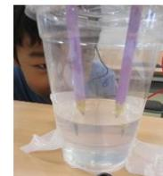
蓄えられた酸素と水素から電気が発生するため、LEDが点灯する。電子オルゴールにつなげば、蓄えた電気を使ってオルゴールの音色が流れる。
