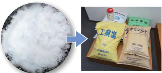
排ガス中の塩化水素や硫黄酸化物は、バグフィルタに重曹系の脱塩剤ソルティクル<sup>®</sup>を吹き込み、これと反応させて除去します。反応後の生成物を回収し精製したものが「精製塩」で、冬に雪が積もる地方の道路の凍結防止剤や、プールの滅菌剤の原料などとして利用されます。
