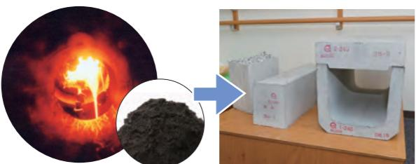
燃焼溶融炉で熱分解カーボンを燃やしてできた灰を溶かしてできる砂粒のようなものが「溶融スラグ」です。道路のアスファルト舗装や、コンクリート二次製品の材料として利用されます。
